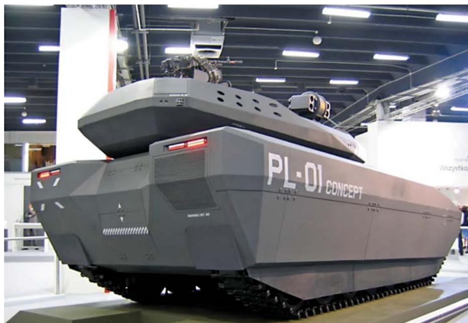
На задњем делу тенка PL-01 је отвор за посаду и бојну муницију, а десно од њега велики издув – хладњак издувних гасова. На боку куболе је лансер активног система заштите иза којег су бацачи димних кућија.
