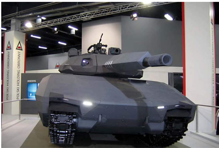
Карактеристике тенка PL-01 су дебела угласта облога цеви и вишекоморна гасна кочница
